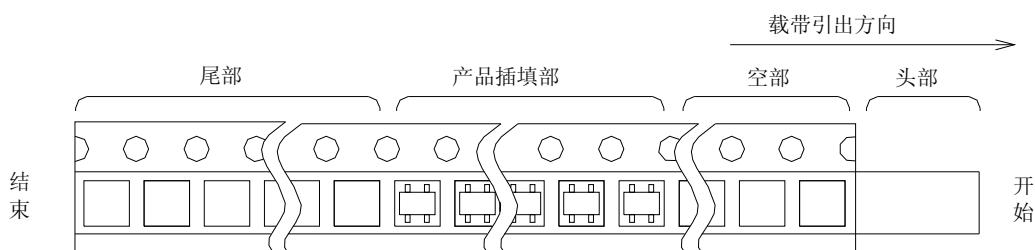
(1) - 1. 素子印刷面在盖带侧，胶带引出方向与素子的长边侧保持一致后再封装。
